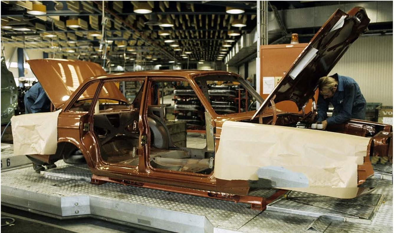
Als welterstes Auto wurde der Volvo 164 nicht mehr am Fließband, sondern ab diesem Modelljahr 1974 im neu errichteten Werk in Kalmar, an der schwedischen Ostküste, in Gruppenarbeit auf den weltweit berühmt gewordenen „Montage-Inseln“ hergestellt.
