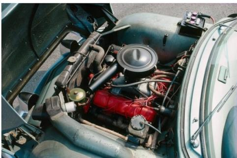
Dieses Volvo 3,6 Liter V8-Triebwerk fand einige Jahre später in modifizierter Form mit der Bezeichnung B36 in den 3 Tonner Kleinlastwagen L420 "Snabbe" (1956-1966) und 5 Tonner L430 "Trygge" (1957-1966) seinen Platz.
