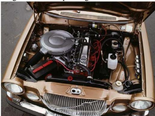
Seit August 1968 bis zum Modelljahr 1971 gab es keine markanten Änderungen. Im Herbst 1971, also im Hinblick auf das Modelljahr 1972, wurde nebst dem B30 A-Motor neu auch die Einspritz-Version mit der Bezeichnung B30 E (USA B30 F) eingeführt. Der Motor leistete als B30 E 160 DIN-PS (175 SAE-PS) und das Modell wurde als „164 E“ bezeichnet. Pünktlich zum Modelljahr 1973 im Herbst 1972 unterzogen die Designer in Göteborg den Volvo 164 einer optischen Kur.
